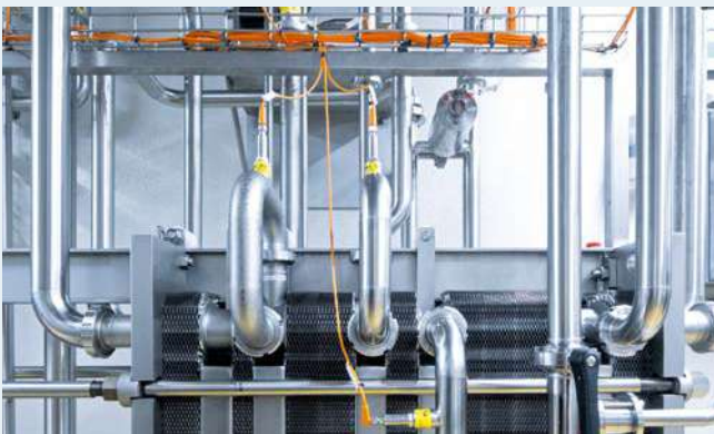
Componente central de la instalación: intercambiador de calor de placas para una regulación exacta de la temperatura de la leche cruda
