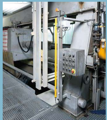
Control de seguridad de un filtro-prensa de cámara.
