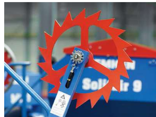
Supervisión del eje de sembrado con detector inductivo
